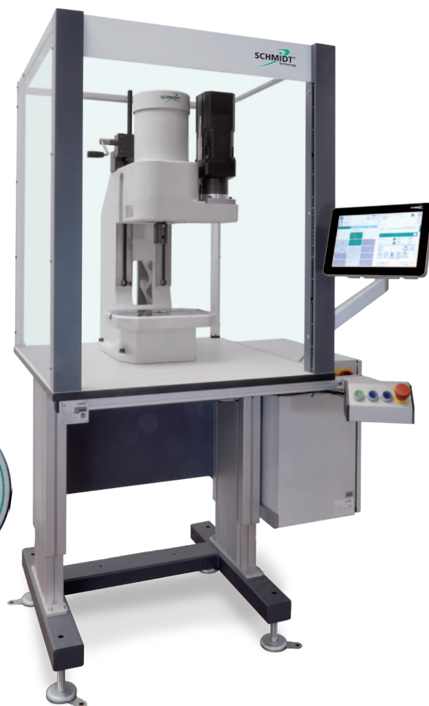
Composant de sécurité barrières immatérielles avec SCHMIDT® ElectricPress 347 , PressControl 700 et support de presse PU 20
