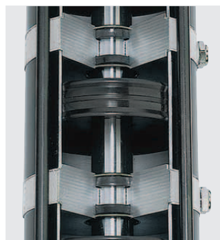
Pneumatikzylinder mit Kolben und Magnetbausatz für die Endlagenabfrage über Zylinderschalter
